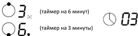
Когда таймер приготовления истекает, соответствующая зона приготовления автоматически выключается и показывает «Н».
