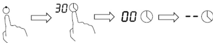
Когда таймер приготовления истекает, соответствующая зона приготовления автоматически выключается и показывает «Н».
