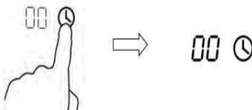
4. После настройки таймера начнется обратный отсчет. Дисплей таймера будет отображать остаток заданного времени, а индикатор таймера будет мигать в течение 5 секунд.
